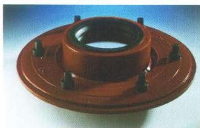
Данный элемент прохождения через кровлю выполнен из ВЧШГ и состоит из сочетания двух фланцев для крепления битумных изоляционных материалов и высокополимерных пленок. Профильное уплотнение из EPDM.
