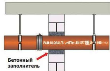
Для горючих труб (ПНД, ПВХ, ПП и т.д.) размером более чем DN 32, результаты измерений и испытаний распространения пожара являются необходимым требованием для того, чтобы могли быть применены правила пожарной безопасности. *См. рекомендации по установке в соответствии с MLAR*
