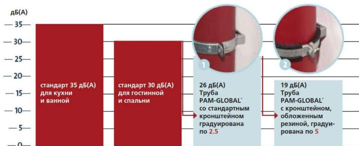
Соответствующие результаты испытаний по EN 14366 получены для расхода 2 л/с и толщины стенок трубы 250±50 кг/м<sup>2</sup> (лаборатория IBP)
