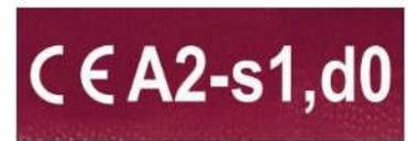
Для строительной продукции реакция на воздействие огня оценивается на основе стандартизированных тестов и описана в эксплуатационной классификации EUROCLASS. Для полного ассортимента - труб, фитингов, хомутов и дополнительного оборудования SAINT-GOBAIN PAM была получена отличная классификация по EUROCLASS: **A2, S1-d0**, в настоящее время отмечаемая на продукции.
