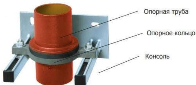
Чугунная опора с вулканизированной резиной укладывается под опорное кольцо кронштейна стояка. Боковые накладки с отверстием служат для наложения и крепления на консолях или шинах с пазами. Для DN 50-100 могут применяться готовые консоли.
