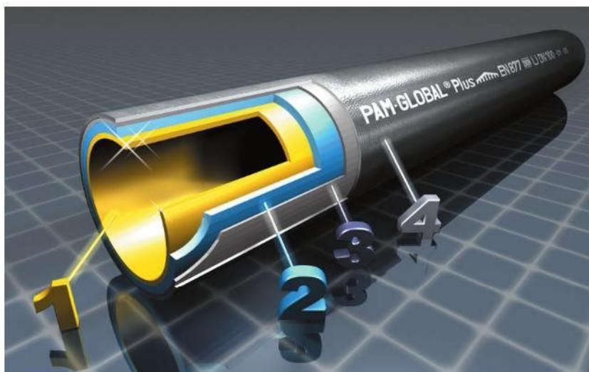
Внутреннее покрытие труб PAM-GLOBAL® PLUS усилено для противодействия химическому или термическому воздействию, вызванному проводимыми агрессивными жидкостями. Она состоит из двух слоев. Внешнее поверхностное покрытие обладает преимуществом за счет антикоррозионного цинкового покрытия, обеспечивающего защиту посредством гальванического эффекта. Действие состоит из двух частей: формирование стабильного защитного слоя из нерастворимых солей цинка и самовосстановление при любых повреждениях.
