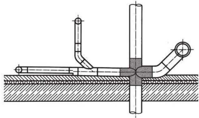
Угол входа под 45° является двусторонним, что позволяет устанавливать комбинированный отвод в повернутом на 180° положении.
