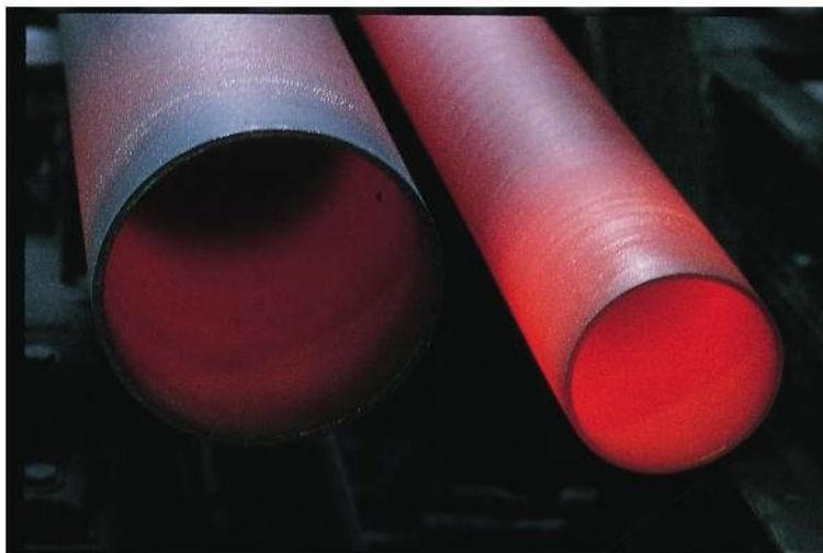
В процессе центробежного литья Де Лаво расплавленный металл постепенно вводится во вращающуюся на высокой скорости стальную форму.
