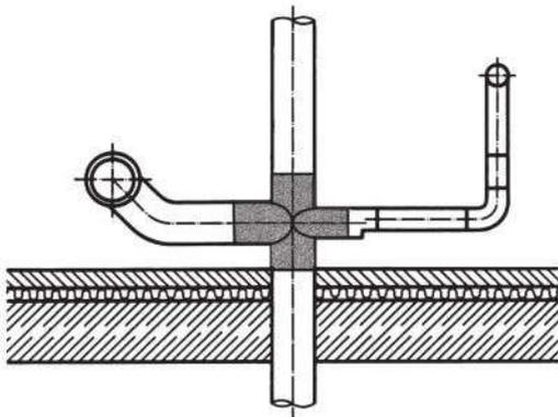
Комбинированный отвод позволяет подсоединять санитарный узел и другие элементы водопровода (например, ванную) на уровне пола.
