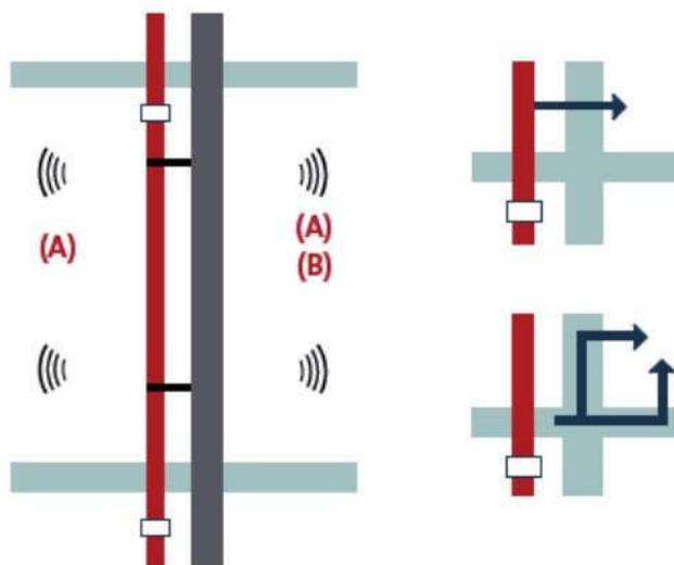
Сточные и дождевые воды являются причиной образования шума между помещениями, передаваемого по воздуху и через конструкцию, который обычно является результатом смешанного потока, когда труба заполнена водой и воздухом. При таких обстоятельствах труба будет распространять шум за пределы облегченных потолков, встроенных шкафов и приравненных к ним помещений повсюду, где имеется соприкосновение с ней.
