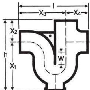
Доступность прочистки дна для DN 50 до 150.
